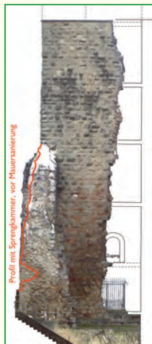
Abb. 2: Ergänzte Bestandsdokumentation des Bergfrieds und der Schildmauer auf Basis eines 3D-Laserscans sowie des Aufmaßes des Büros Klaus Bingenheimer und Emil Hädler (heute Studio Baukultur) von 1987. Die mit den Sanierungen geschlossenen Sprenglöcher bzw. Kanäle in der Schildmauer sind durch rote Linien ergänzt.
